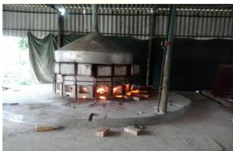
चित्र: 1:19 उच्च सघनता वाले संश्लिष्ट परिरक्षण संघात बनाने के लिए लाल गाद का सिरामिक प्रसंस्करण
