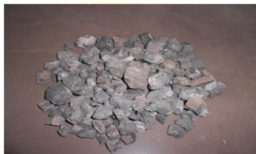
चित्र: 1:19 उच्च सघनता वाले संश्लिष्ट परिरक्षण संघात बनाने के लिए लाल गाद का सिरामिक प्रसंस्करण
