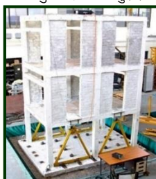
चित्र: 1.29 ख एक्स प्लेट एडीएस घटकों के साथ पुनः संयोजित ओजीएस भवन का शेक टेबल परीक्षण
