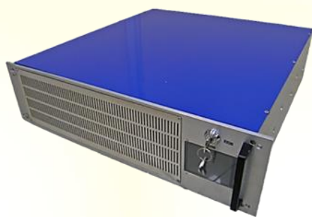
चित्र: 1.25 पैकिंग के तहत 10W Tm-फाइबर लेजर मॉड्यूल का आदिप्ररूप Tm-डॉप्ड फाइबर लेजर का लेजर पावर बनाम लांच्ड 3 पम्प पावर
