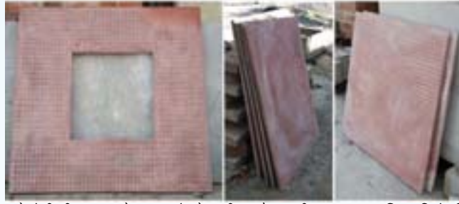
चित्र: 7.20 टीआरसी पैनल्स नवोन्मेषी ग्री-कास्ट सोल्यूशंस है जो ग्रामीण और शहरी अवसंरचना की प्रगति के लिए उपयोग किए जा सकते हैं। पैनल्स भार सहन न करने वाली दीवारों का निर्माण करने के लिए उपयुक्त हैं। तीव्र और लागत प्रभावी शौचालयों का निर्माण करने के लिए उपयुक्त हैं।
