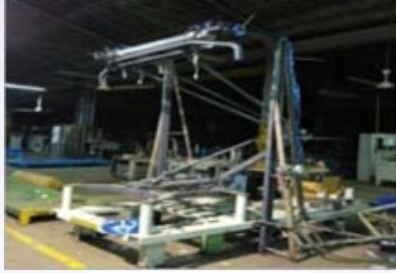
चित्र 5.2 नियंत्रण बल और नियंत्रण स्थिति के मापन हेतु ऑप्टिकल स्ट्रैन सेंसरों के मूल्यांकन हेतु टेस्ट बेड
