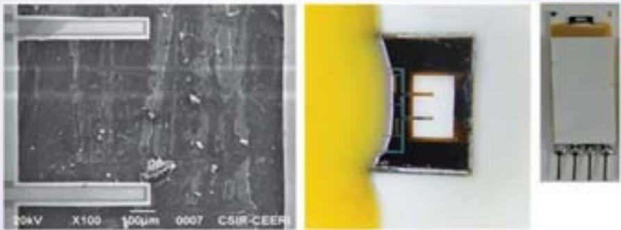
चित्र 5.8 (i) माइक्रो केंटीलीवर आधारित सेंसिंग प्लेटफॉर्म की एसईएम छवि (ii) अंतिम दो प्रदेय प्रोटोटाइप (करीबी दृश्य) (iii) अंतिम प्रदेय प्रोटोटाइप
