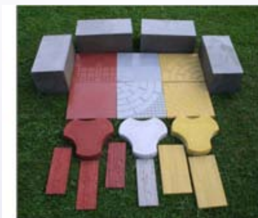
चित्र: 10.6.10. कोटा स्टोन अपशिष्टों के इस्तेमाल से टाइल्स, पेवर ब्लॉक्स, वॉल टाइल्स तथा हल्के ब्लॉक
