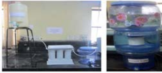
चित्र 8.3.1 (क) 2-5 mg/l फ्लोराइड पानी के उपचार हेतु लागू (ख) 1.5-2 ppm फ्लोराइड पानी के उपचार हेतु लागू
