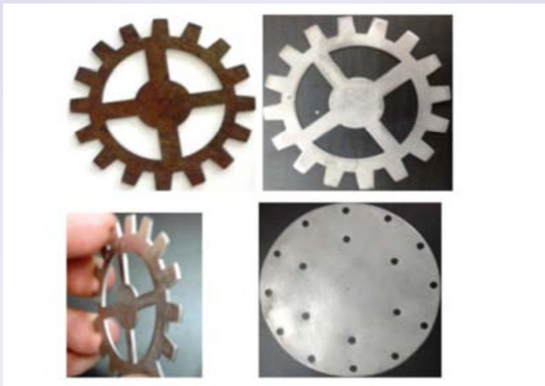
चित्र 8.3.16 इलेक्ट्रोलेस RGO-Ni नैनोकम्पोजिट कोटिड घटक
