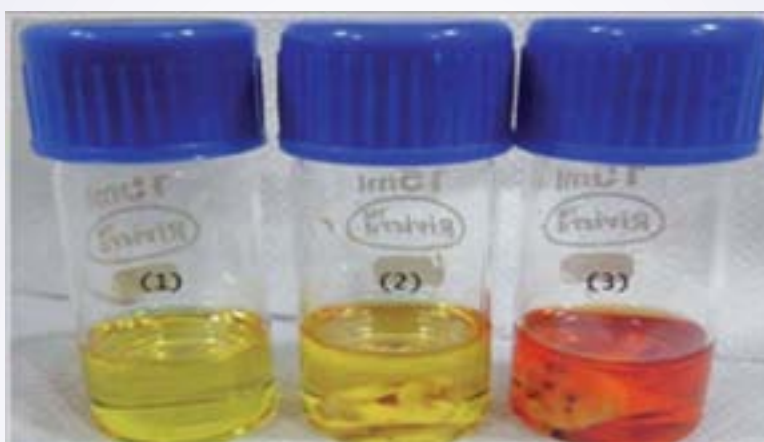
चित्र : 8.3.9 (क) सेंसर सोल्यूशन; (ख) गैर-फ्लूओरोसिस टूथ नमूने के साथ सेंसर शांत रहा; (ग) फ्लूओरोसिस प्रभावित टूथ नमूने को डूबोने पर सेंसर 5 मिनट के भीतर लाल रंग हो जाता है।
